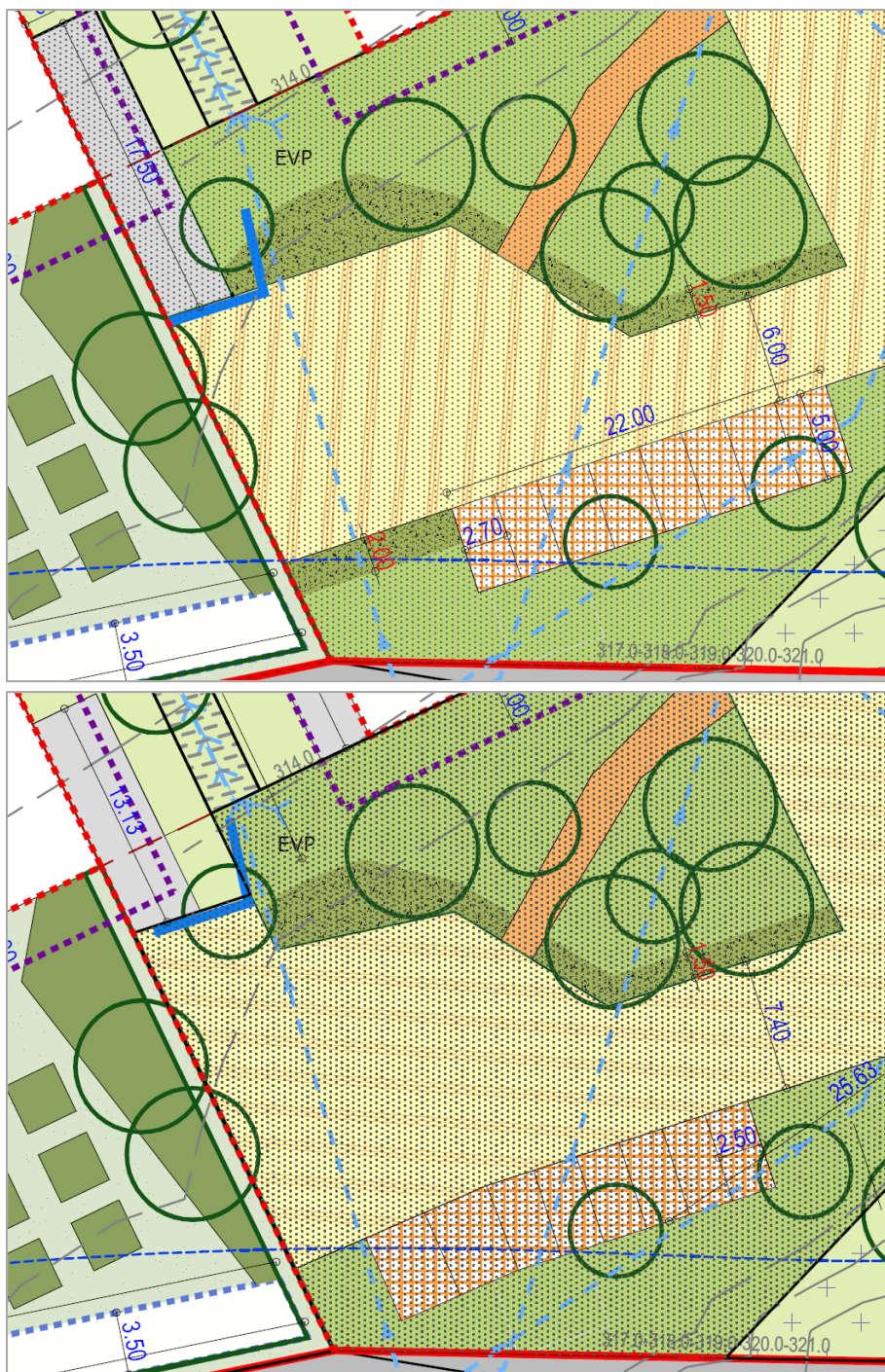
Figure 10 : Extrait de la partie graphique du PAP „Geetz“ en vigueur (en haut) et modifiée (en bas) – modification de la géométrie de la placette. Source : CO3, 2025
