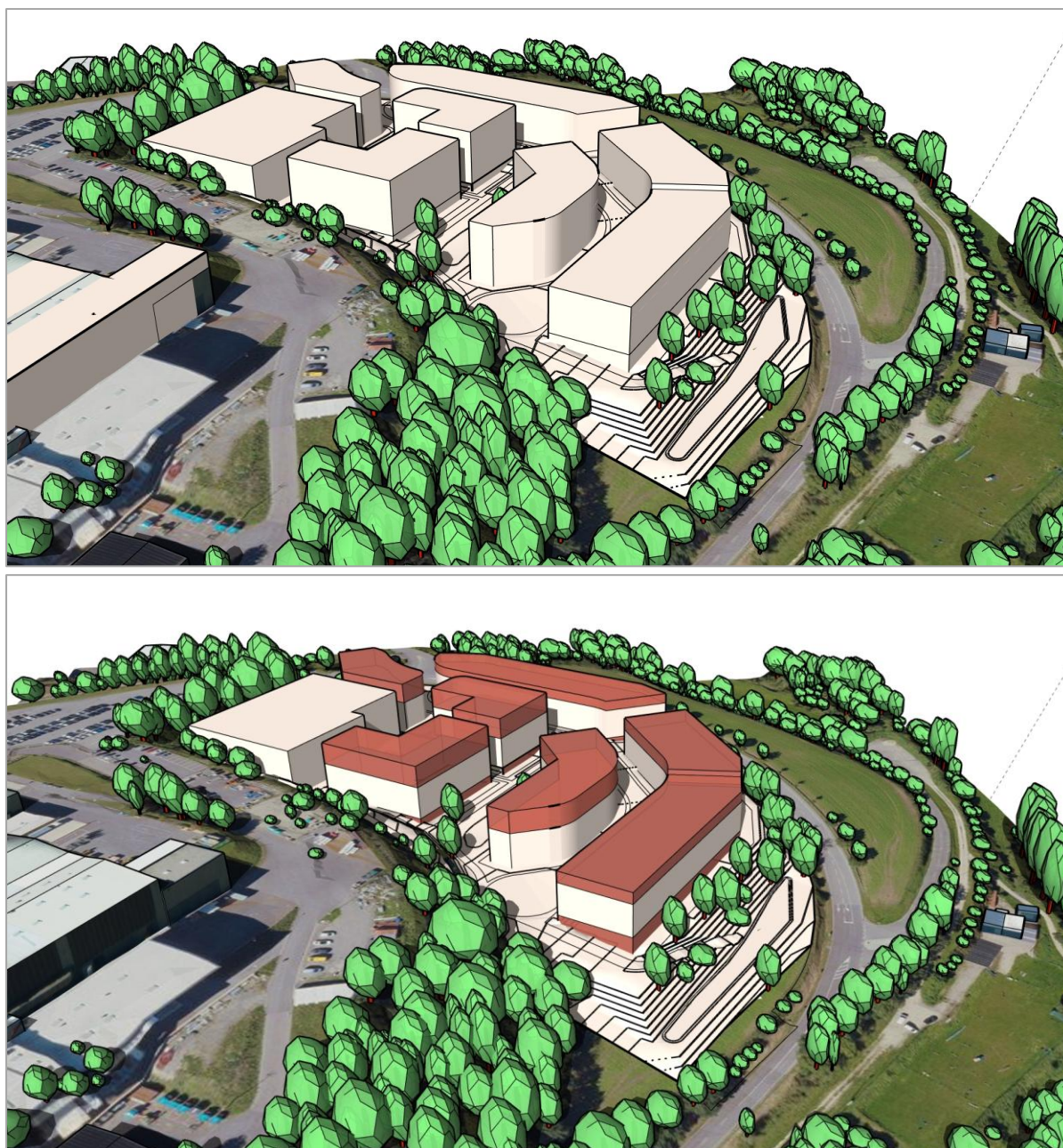
Figure 12: Axonométries avec vue vers l'Ouest. En haut, les gabarits maximums sont représentés, conformes aux directives du présent PAP. En bas, exemple de configuration du bâti avec des étages pour bureaux/services représentés en rouge, en association avec des halls (à titre indicatif). Source : CO3, 2025
