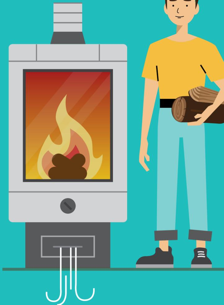
Une **bonne arrivée d'air** permet une combustion complète et propre.
